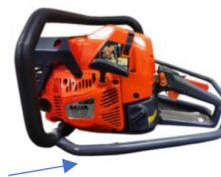
Puxe a pega do Starter. O Motor deverá arrancar após uma ou duas tentativas. Quando o motor arrancar coloque o interruptor em ON
