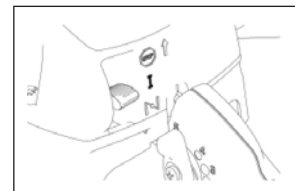
7 发动机点火后，将控制开关调到RUN(运行)的位置，再次拉启动盘。一般需要拉动1到2次。
