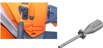
40000303 - SCHROEVENDRAAIER OM DE CARBURATEUR AF TE STELLEN (OLD MASTER) 40000327 - SCHROEVENDRAAIER OM DE CARBURATEUR AF TE STELLEN (NEW MASTER)
