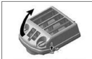
Limpe com um desengordurante adequado, enxágue com água e seque com ar comprimido. Substitua o filtro se estiver entupido ou danificado
