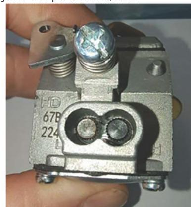
Insira a chave especial conforme indicado na foto e ajuste os parafusos L, H e T
