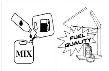
Misture bem o Óleo e a Gasolina num recipiente próprio antes de encher o depósito. Abasteça apenas em espaços bem ventilados e longe de equipamento que produzam faíscas como por ex. Motodiscos e Esmeriladoras
