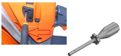
40000303 - SCHROEVENDRAAIER OM DE CARBURATEUR AF TE STELLEN (OLD MASTER) 40000327 - SCHROEVENDRAAIER OM DE CARBURATEUR AF TE STELLEN (NEW MASTER)
